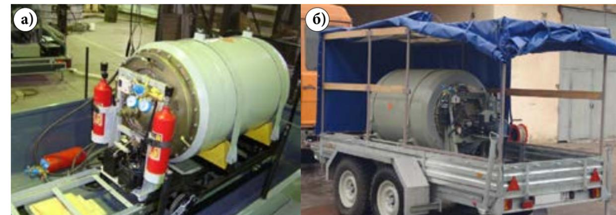
Рис. 4. Взрывозащитные контейнеры: а) ЭТЦ 3МК; б) ЭТЦ 4МК
