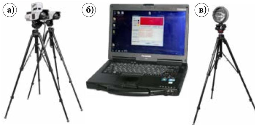
Рис. 2. СДКВС: а) фотоприемные устройства; б) монитор; в) инфракрасный излучатель
