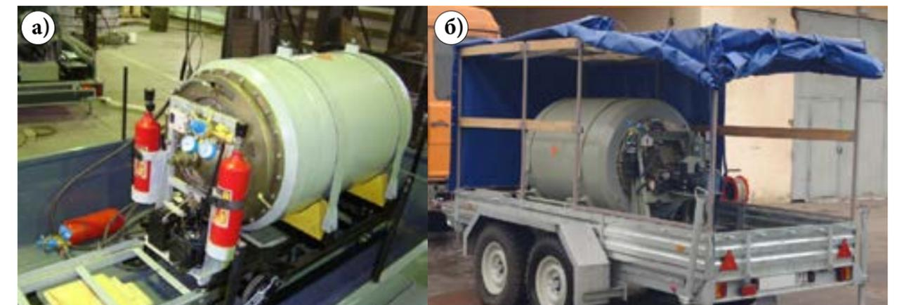
Рис. 4. Взрывозащитные контейнеры: а) ЭТЦ 3МК; б) ЭТЦ 4МК
